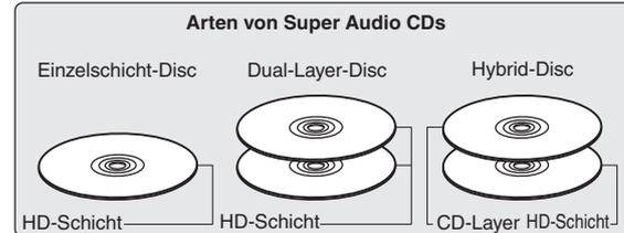
Die HD-Schicht ist eine Schicht von High Density-Signalen für Super Audio CDs.
