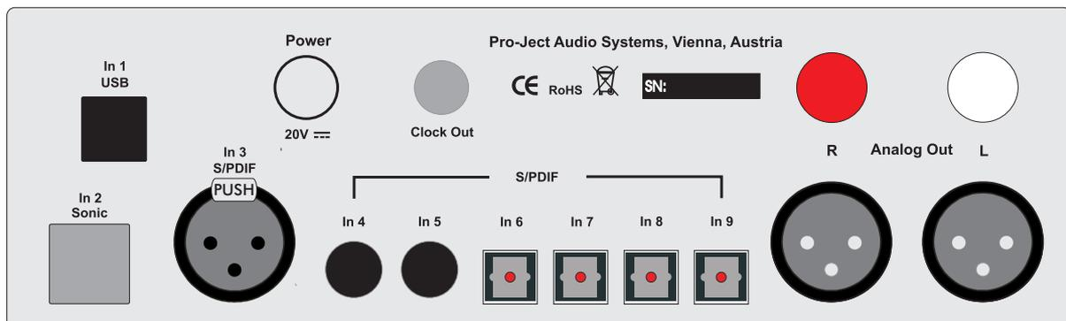
Nehmen Sie Anschlüsse und das Trennen von Anschlüssen, **mit Ausnahme des Computer-Anschlusses**, ausschließlich bei **vom Netz getrennten Gerät** vor. Der Anschluss an den **eingeschalteten Computer** darf erst **nach Netzanschluss und Einschalten** der DAC Box RS erfolgen.
